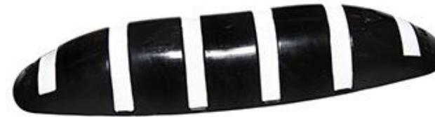
Delimitador de carril en Policloruro de Vinilo flexible (PVC), totalmente reciclable, con bandas BLANCAS integradas en la pieza mediante pintura vial acrílica con micro esferas, especialmente diseñado para facilitar la absorción de impactos. Materiales totalmente reciclables. Fácil instalación mediante 3 tornillos, el paso de tornillo esta reforzado con arandelas sobreinyectadas. Resistente a la abrasión y rayos UV.
