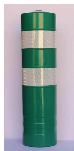
Hito flexible, soporta grandes impactos, debido a la alta calidad de la materia prima tiene alta memoria de forma. Incorpora aditivos Anti-UV. Doble banda reflectante tipo Diamond Grade 3. La base lleva Disco de acero y tornillo incorporado para fijación a pavimento.
